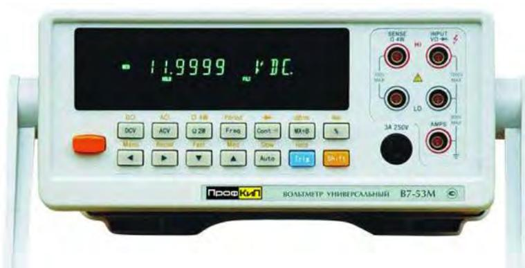
Вольтметр универсальный ПрофКиП В7-53М предназначен для измерения: постоянного и переменного напряжений, силы постоянного и переменного токов, сопротивления постоянному току, частоты. Прибор обеспечивает измерение среднеквадратического значения (СКЗ) сигналов переменного тока несинусоидальной формы с больш ПрофКиП им коэффициентом амплитуды. Прибор рассчитан на работу в составе автоматизированных систем с интерфейсом RS-232C. Обладает высоким быстродействием, стабильностью и линейностью.
