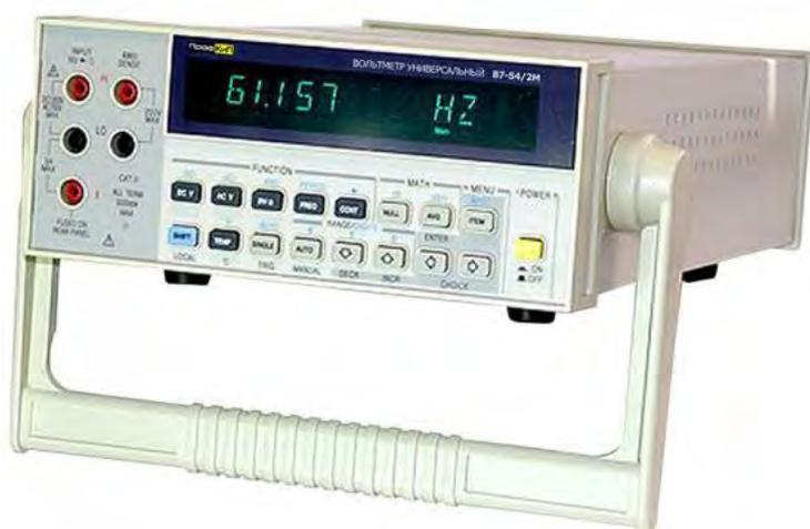
Вольтметр универсальный ПрофКиП В7-54/2М представляет собой прибор с  $5\frac{1}{2}$  разрядным дисплеем, интерфейсами RS-232 и GPIB, с возможностью дистанционного управления. ПрофКиП В7-54/2М позволяет проводить измерения постоянного тока и напряжения, переменного тока и напряжения, измерение сопротивления по двух и четырехпроводной схеме, позволяет измерять частоту, период,
