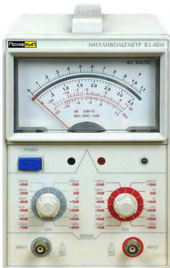
Милливольтметр ПрофКиП ВЗ-48М предназначен для измерения напряжения, имеет стрелочную индикацию, позволяет производить измерения постоянной и переменной составляющих в частотном диапазоне до 100 кГц.
