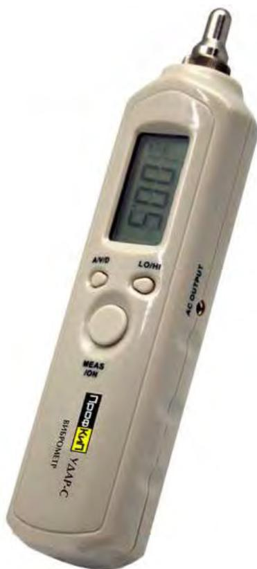
Портативный цифровой виброметр ПрофКиП Удар-С использует для измерения уровня вибрации пьезоэлектрический преобразователь ускорения, который передает аналоговый входящий сигнал вибрации к центральному блоку, который преобразует его в электрический сигнал, анализирует и выдает на дисплей значения ускорения, скорости, и смещения. Виброметр ПрофКиП Удар-С широко используется в энергетике, нефтехимии, производстве машин, металлургии, транспорте, и т.д.
