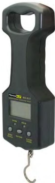
Весы цифровые ПрофКиП ВЦ-835 функционально являются цифровым безменом. Помимо функции взвешивания объектов, вес которых может быть в пределах от 0 кг до 25 кг, цифровой безмен умеет измерять температуру в диапазоне от -20°C до 60°C и относительную влажность воздуха в пределах от 0% до 99%. В корпус электронных весов интегрирована рулетка для измерения габаритов предметов.
