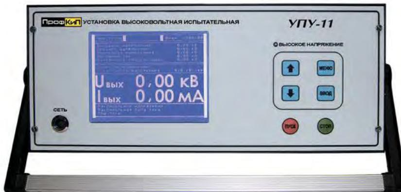
Установка высоковольтная измерительная ПрофКиП УПУ-11 предназначена для генерирования напряжения постоянного и переменного тока синусоидальной формы частотой 50 Гц, а также измерения напряжения и силы переменного и постоянного токов при проведении испытаний и диагностировании изоляции силовых кабелей, изоляции электрооборудования, ограничителей перенапряжений, твердых диэлектриков, средств защиты.
