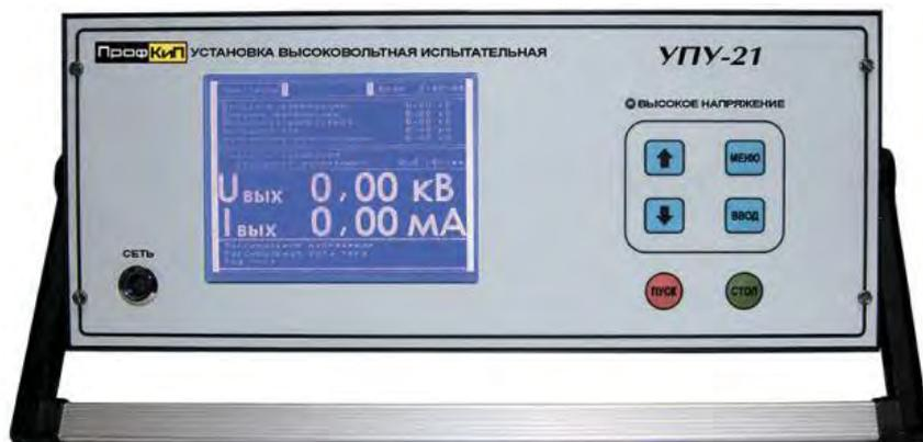
Установка высоковольтная измерительная ПрофКиП УПУ-21 предназначена для генерирования напряжения постоянного и переменного тока синусоидальной формы частотой 50 Гц, а также измерения напряжения и силы переменного и постоянного токов при проведении испытаний и диагностировании изоляции силовых кабелей, изоляции электрооборудования, ограничителей перенапряжений, твердых диэлектриков, средств защиты.
