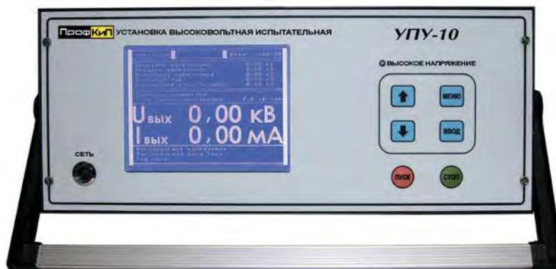
Установка высоковольтная измерительная ПрофКиП УПУ-10 предназначена для генерирования напряжения постоянного и переменного тока синусоидальной формы частотой 50 Гц, а также измерения напряжения и силы переменного и постоянного токов при проведении испытаний и диагностировании изоляции силовых кабелей, изоляции электрооборудования, ограничителей перенапряжений, твердых диэлектриков, средств защиты.
