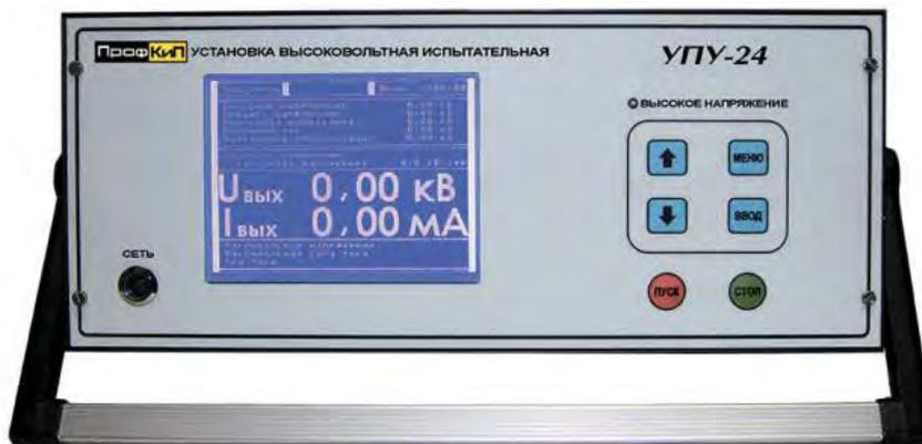
Установка высоковольтная измерительная ПрофКиП УПУ-24 предназначена для генерирования напряжения постоянного и переменного тока синусоидальной формы частотой 50 Гц, а также измерения напряжения и силы переменного и постоянного токов при проведении испытаний и диагностировании изоляции силовых кабелей, изоляции электрооборудования, ограничителей перенапряжений, твердых диэлектриков, средств защиты.
