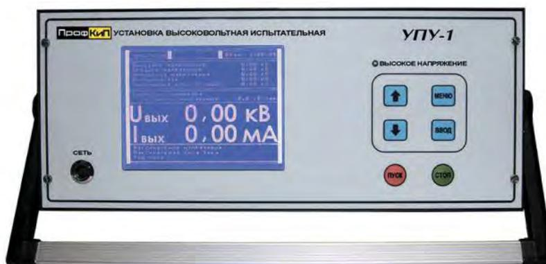
Установка высоковольтная измерительная ПрофКиП УПУ-1 предназначена для генерирования напряжения постоянного и переменного тока синусоидальной формы частотой 50 Гц, а также измерения напряжения и силы переменного и постоянного токов при проведении испытаний и диагностировании изоляции силовых кабелей, изоляции электрооборудования, ограничителей перенапряжений, твердых диэлектриков, средств защиты.
