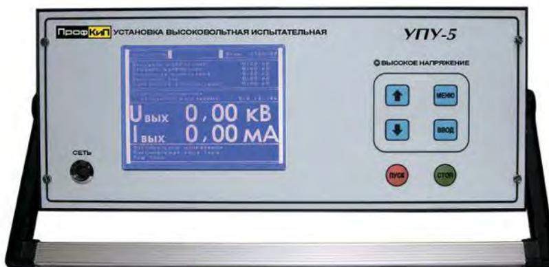
Установка высоковольтная измерительная ПрофКип УПУ-5 предназначена для генерирования напряжения постоянного и переменного тока синусоидальной формы частотой 50 Гц, а также измерения напряжения и силы переменного и постоянного токов при проведении испытаний и диагностировании изоляции силовых кабелей, изоляции электрооборудования, ограничителей перенапряжений, твердых диэлектриков, средств защиты.
