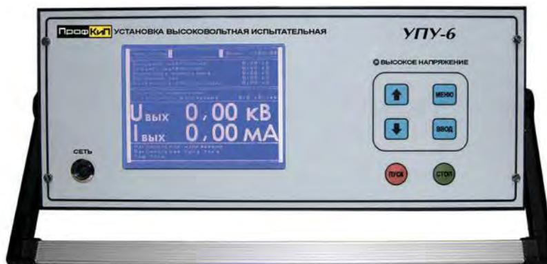
Установка высоковольтная измерительная ПрофКиП УПУ-6 предназначена для генерирования напряжения постоянного и переменного тока синусоидальной формы частотой 50 Гц, а также измерения напряжения и силы переменного и постоянного токов при проведении испытаний и диагностировании изоляции силовых кабелей, изоляции электрооборудования, ограничителей перенапряжений, твердых диэлектриков, средств защиты.
