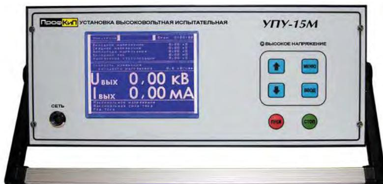
Установка высоковольтная измерительная ПрофКип УПУ-15М предназначена для генерирования напряжения постоянного и переменного тока синусоидальной формы частотой 50 Гц, а также измерения напряжения и силы переменного и постоянного токов при проведении испытаний и диагностировании изоляции силовых кабелей, изоляции электрооборудования, ограничителей перенапряжений, твердых диэлектриков, средств защиты.
