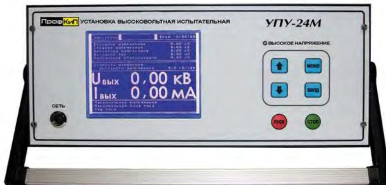
Установка высоковольтная измерительная ПрофКип УПУ-24М предназначена для генерирования напряжения постоянного и переменного тока синусоидальной формы частотой 50 Гц, а также измерения напряжения и силы переменного и постоянного токов при проведении испытаний и диагностировании изоляции силовых кабелей, изоляции электрооборудования, ограничителей перенапряжений, твердых диэлектриков, средств защиты.
