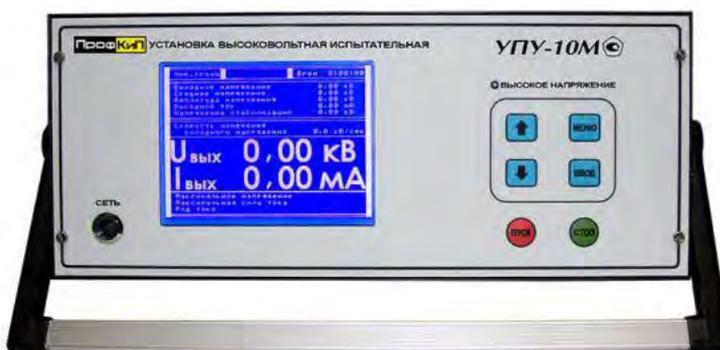
Установка высоковольтная измерительная ПрофКиП УПУ-10М предназначена для генерирования напряжения постоянного и переменного тока синусоидальной формы частотой 50 Гц, а также измерения напряжения и силы переменного и постоянного токов при проведении испытаний и диагностировании изоляции силовых кабелей, изоляции электрооборудования, ограничителей перенапряжений, твердых диэлектриков, средств защиты.
