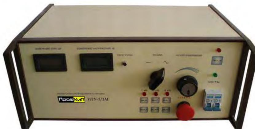
Установка высоковольтная измерительная ПрофКип УПУ-1/1М предназначена для генерирования напряжения постоянного и переменного тока синусоидальной формы частотой 50 Гц, а также измерения напряжения и силы переменного и постоянного токов при проведении испытаний и диагностировании изоляции силовых кабелей, изоляции электрооборудования, ограничителей перенапряжений, твердых диэлектриков, средств защиты.
