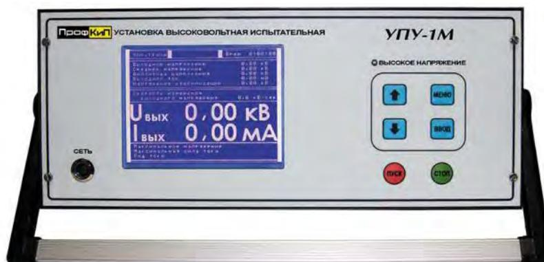
Установка высоковольтная измерительная ПрофКиП УПУ-1М предназначена для генерирования напряжения постоянного и переменного тока синусоидальной формы частотой 50 Гц, а также измерения напряжения и силы переменного и постоянного токов при проведении испытаний и диагностировании изоляции силовых кабелей, изоляции электрооборудования, ограничителей перенапряжений, твердых диэлектриков, средств защиты.
