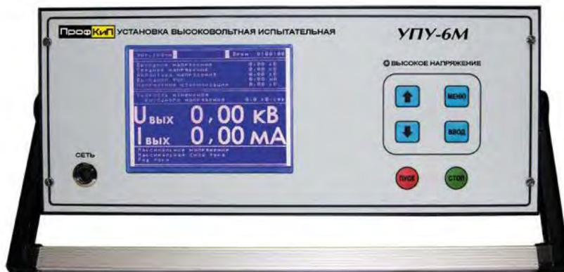
Установка высоковольтная измерительная ПрофКип УПУ-6М предназначена для генерирования напряжения постоянного и переменного тока синусоидальной формы частотой 50 Гц, а также измерения напряжения и силы переменного и постоянного токов при проведении испытаний и диагностировании изоляции силовых кабелей, изоляции электрооборудования, ограничителей перенапряжений, твердых диэлектриков, средств защиты.
