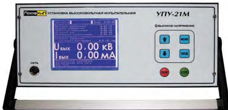
Установка высоковольтная измерительная ПрофКиП УПУ-21М предназначена для генерирования напряжения постоянного и переменного тока синусоидальной формы частотой 50 Гц, а также измерения напряжения и силы переменного и постоянного токов при проведении испытаний и диагностировании изоляции силовых кабелей, изоляции электрооборудования, ограничителей перенапряжений, твердых диэлектриков, средств защиты.
