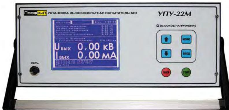
Установка высоковольтная измерительная ПрофКип УПУ-22М предназначена для генерирования напряжения постоянного и переменного тока синусоидальной формы частотой 50 Гц, а также измерения напряжения и силы переменного и постоянного токов при проведении испытаний и диагностировании изоляции силовых кабелей, изоляции электрооборудования, ограничителей перенапряжений, твердых диэлектриков, средств защиты.
