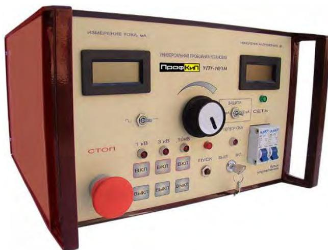
Установка высоковольтная измерительная ПрофКиП УПУ-10/1М предназначена для испытания изоляции электротехнического оборудования и материалов переменным синусоидальным напряжением частотой 50 Гц и выпрямленным напряжением отрицательной полярности, регулируемым в пределах от 0 кВ до 10 кВ с выходным током до 100 мА. Применяется в электротехнике и энергетике. Благодаря повышенному выходному току установка пробойная универсальная ПрофКиП УПУ-10/1М может быть использована для
