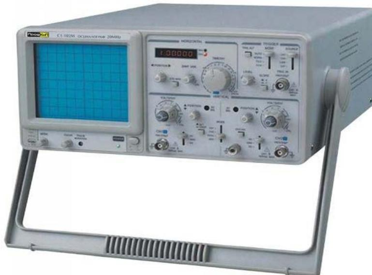
Осциллограф универсальный ПрофКип С1-102М предназначен для исследования формы электрических сигналов путем визуального наблюдения на экране электронно-лучевой трубки (ЭЛТ) и измерения их амплитудных и временных характеристик. Область применения осциллографа универсального ПрофКип С1-102М – контроль параметров, наладка и ремонт различных радиоэлектронных устройств в лабораториях и промышленных условиях.
