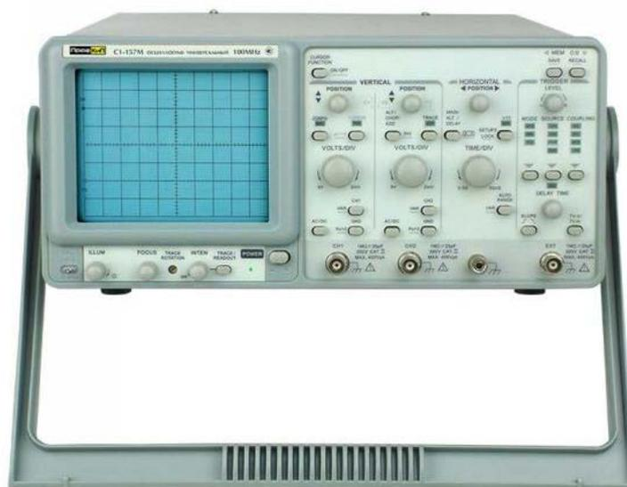
Осциллограф универсальный ПрофКип С1-157М предназначен для исследования формы электрических сигналов путем визуального наблюдения на экране электронно-лучевой трубки (ЭЛТ) и измерения их амплитудных и временных характеристик. Осциллограф универсальный ПрофКип С1-157М быть использован для контроля электрических параметров в промышленных и научных исследовательских лабораториях, ремонтных мастерских, учебных заведениях, в радиолюбительской практике.
