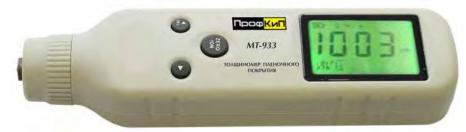
Портативный толщиномер покрытий ПрофКиП МТ-933 используется для измерения толщины покрытий неразрушающим методом. При проведении измерения толщиномер использует электромагнитные волны. В основу работы цифрового толщиномера ПрофКиП МТ-933 положен метод магнитной индукции. Метод позволяет быстро и точно произвести измерение толщины обшивки из любого металла. Толщиномер покрытий ПрофКиП МТ-933 популярен во многих областях за счет своих скромных габаритов и достаточной точности.
