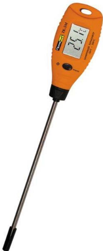
Термометры контактные цифровые типа ТК-5М предназначены для измерений температуры жидких, сыпучих, газообразных сред посредством погружения термопреобразователей в среду (погружные измерения), контактных измерений температуры поверхностей твердых тел (поверхностные измерения).
