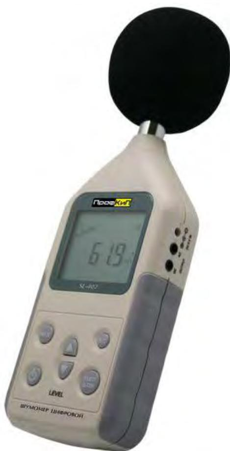
Цифровой шумомер ПрофКип SL-402 - специализированное устройство для измерения характеристик шума. Шумомер дает возможность замерить уровень давления звука. Благодаря своему внутреннему устройству, цифровой шумомер преобразует аналоговый звуковой сигнал, воспринятый микрофоном шумомера в вид цифровой. Таким образом, характеристики звука могут быть отображены на экране шумомера. Электронный шумомер ПрофКип SL-402 используется в широком диапазоне сфер применения.
