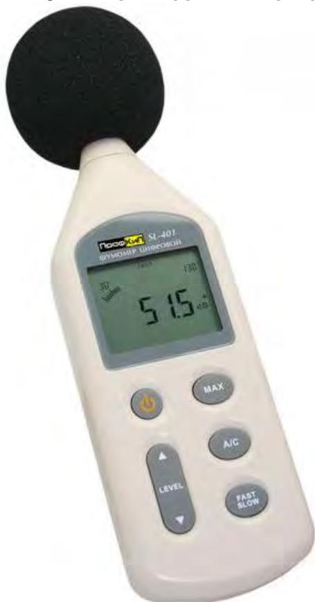
Шумомер ПрофКиП SL-401 является электронным устройством для измерения уровня шума. ПрофКиП SL-401 - измеритель уровня звукового давления, он позволяет измерить элементарные шумы. Цифровой шумомер состоит из конденсаторного микрофона, предусилителя, преобразователя, усилителя, частотного фильтра.
