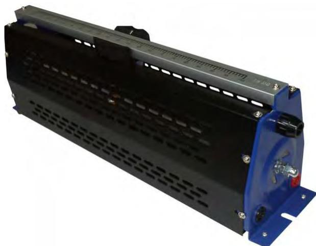
Реостаты сопротивления ползунковые предназначены для плавного регулирования силы тока или напряжения в электрических цепях постоянного и переменного тока. Используются в широкой сфере электронной промышленности при тестировании электрических цепей, автомобилей, лабораторных исследованиях, образовании и т. д.
