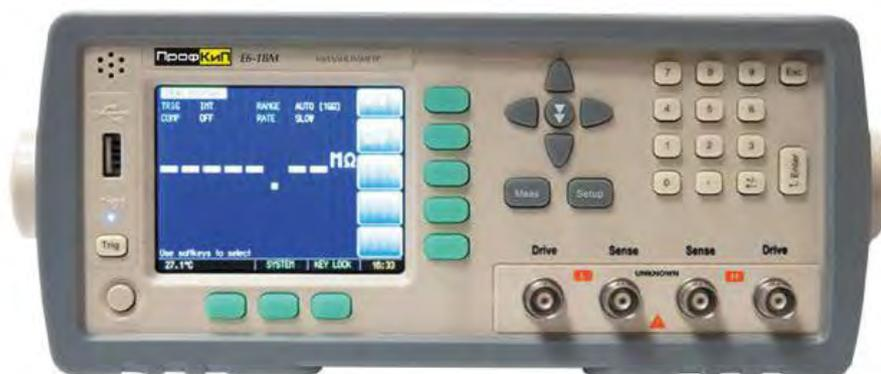
Миллиомметр ПрофКиП Е6-18М предназначен для измерения малых электрических сопротивлений, а также для отбраковки (отбора) элементов сопротивления – резисторов и пр. на предприятиях, в производственных цехах и лабораториях, по заранее заданному порогу сопротивления. Миллиомметр ПрофКиП Е6-18М позволяют осуществлять запись результатов измерения на внешний USB носитель. Прибор может осуществлять работу в режиме внешнего запуска измерений и выдачи результатов компарирования на
