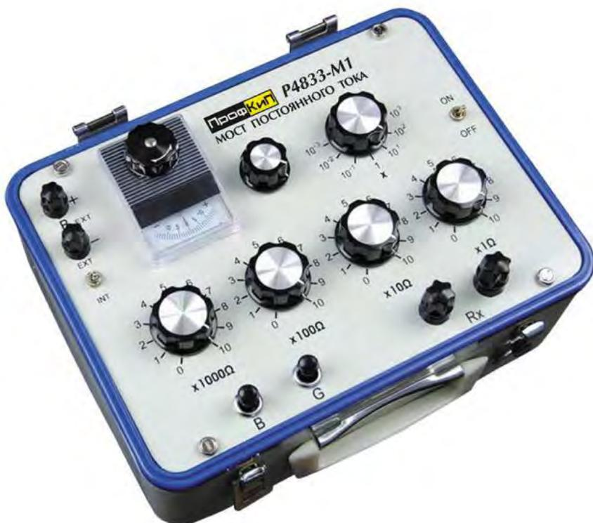
Прибор универсальный измерительный ПрофКиП Р4833-М1 представляет собой измерительный мост (мост для измерения сопротивления по постоянному току). Прибор универсальный измерительный ПрофКиП Р4833-М1 может использоваться для определения величины сопротивления в диапазоне от 1 Ом до 10 МОм. Выполнен в удобном для переноски металлическом корпусе, и представляет собой идеальное оборудование для измерений в лабораторных и полевых условиях.
