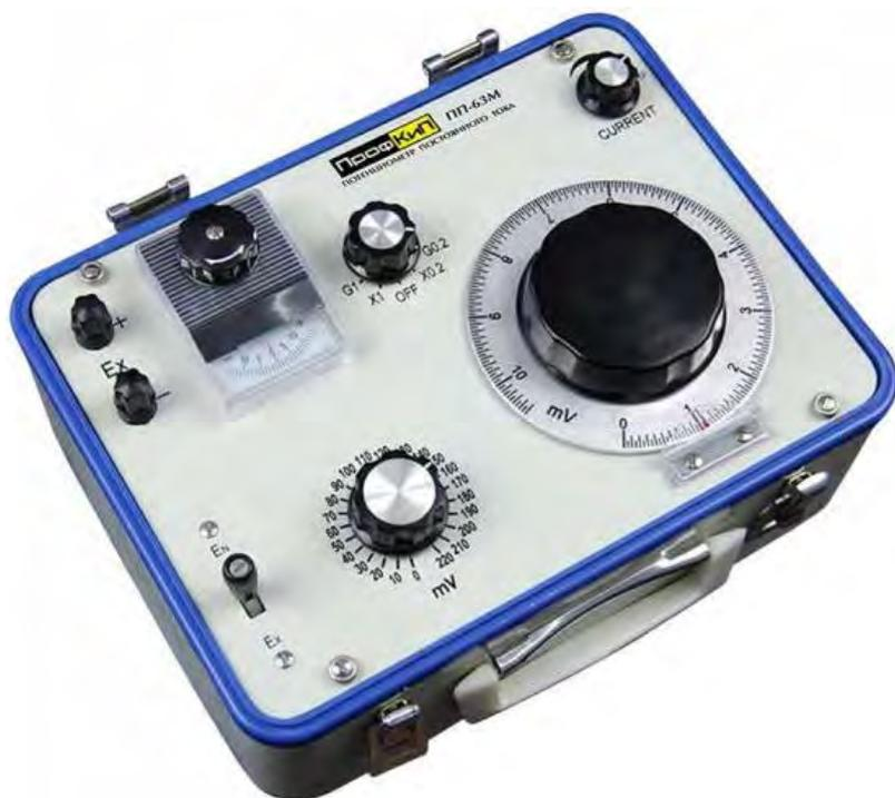
Переносной потенциометр постоянного тока ПрофКиП ПП-63М класса 0.1% со встроенным гальванометром, предназначен для: непосредственного измерения компенсационным методом э.д.с. и напряжений; поверки в цеховых условиях технических термопар и вторичных теплотехнических приборов, работающих с термопарами (пирометрических милливольтметров и автоматических потенциометров); получения плавно регулируемого напряжения постоянного тока.
