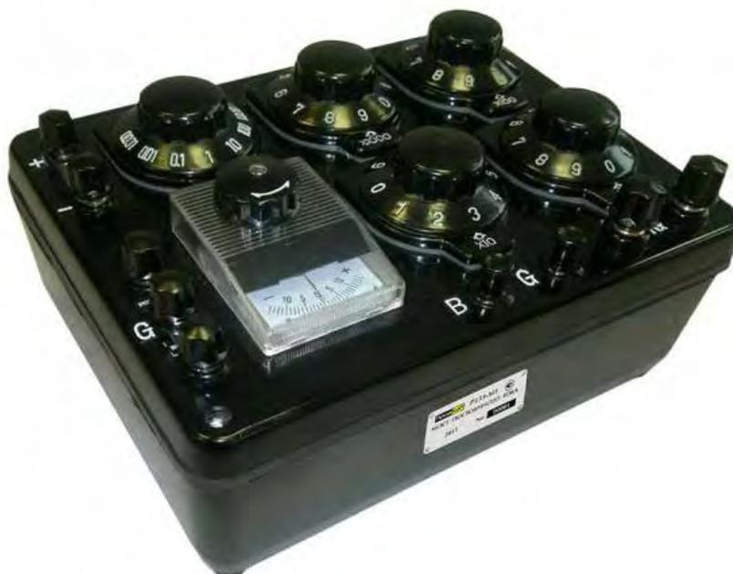
Мост постоянного тока измерительный ПрофКиП Р333-М1 предназначен для измерения значений электрического сопротивления постоянному току и применения в качестве магазина электрического сопротивления в цепях постоянного тока. Также с помощью моста постоянного тока измерительного ПрофКиП Р333-М1 можно измерять расстояние до места повреждения линии по схеме петли Муррея или Варлея и измерять асимметрию проводов.
