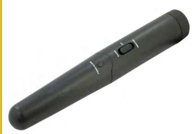
Детектор металла ПрофКиП Дозор-911 в основе действия своего электронного устройства применяет индукцию электромагнитных волн. Металлоискатель может производить детекцию металлических предметов диаметром от 20 см на 360°. Данный функционал также обеспечивается округлой формой корпуса детектора ПрофКиП Дозор-911. Помимо звуковой индикации И светодиодной индикации обнаружения, в приборе реализован бесшумный вибрационный метод.
