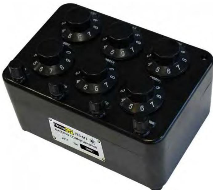
Магазин сопротивлений ПрофКиП Р33-М1 предназначен для воспроизведения значений электрического сопротивления постоянному току и для применения в качестве многозначной меры электрического сопротивления (ММЭС) в цепях постоянного тока.
