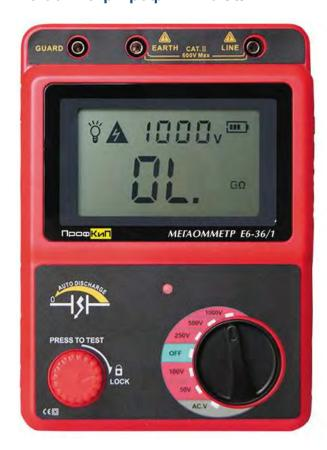
Мегаомметр ПрофКиП Е6-36/1 измеряет сопротивление изоляции в диапазоне от 0 Ом 20 ГОм. Измеритель ДО сопротивления изоляции позволяет производить измерение напряжением от 50 В до 1000 В, которое разбито на 5 режимов. фиксированных Помимо сопротивления, прибор позволяет измерять напряжение электрической цепи. Тестер изоляции ПрофКиП Е6-36/1 при измерении выводит показания на ЖКдисплей, оснащенный подсветкой.
