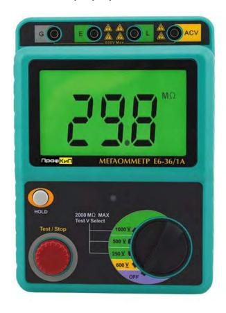
Мегаомметр ПрофКиП Е6-36/1А измеряет сопротивление изоляции в диапазоне от 1 кОм ДО 2000 МОм. Измеритель сопротивления изоляции позволяет производить измерение напряжением от 250 В до 1000 В, которое разбито на 3 фиксированных режима. сопротивления, прибор позволяет измерять напряжение электрической цепи до 600В. Тестер изоляции ПрофКиП Е6-36/1А при измерении выводит показания на ЖКдисплей, оснащенный подсветкой.
