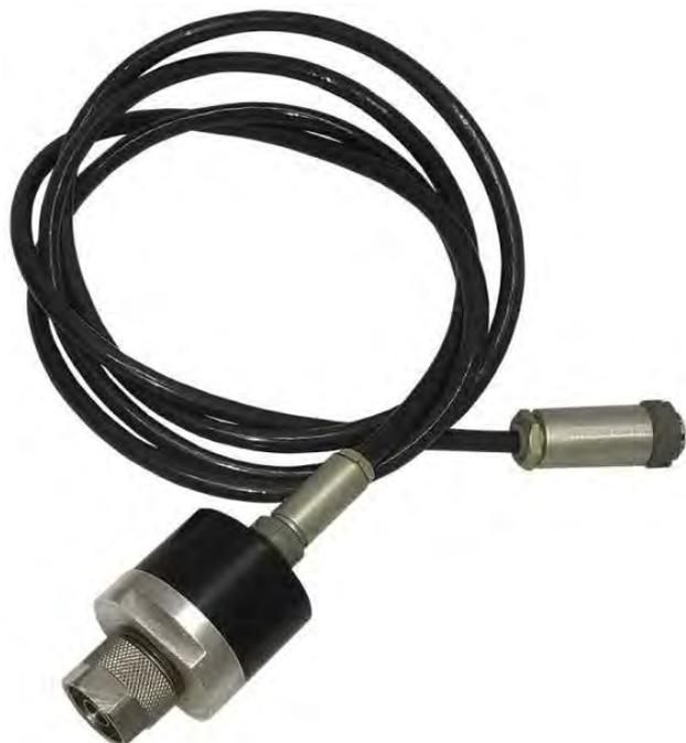
Преобразователь приемный коаксиальный ППК ПрофКиП МЗ-51/2 предназначен для преобразования СВЧ мощности в тепловой вид энергии, для измерения образуемой на выходе ППК термоэлектродвижущей силы (термо-ЭДС, которая пропорциональна подведенной к нему мощности СВЧ сигнала) блоком ваттметра измерительным ПрофКиП Я2М-66М (БИ).
