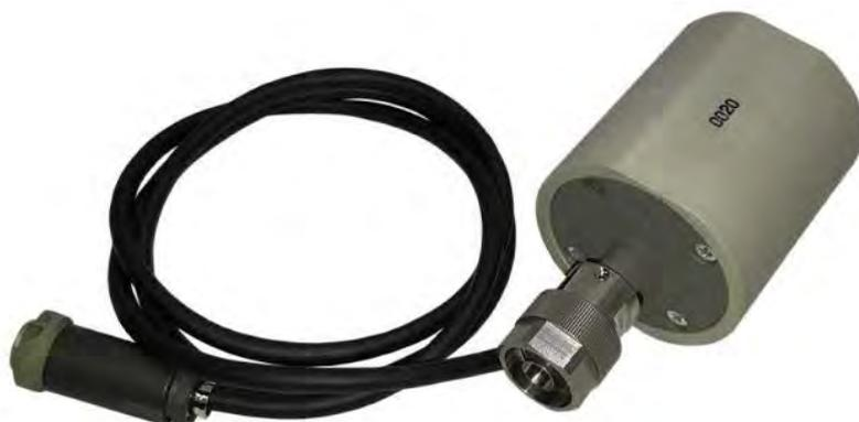
Преобразователь приемный коаксиальный ППК ПрофКиП МЗ-54/1 предназначен для преобразования СВЧ мощности в тепловой вид энергии, для измерения образуемой на выходе ППК термоэлектродвижущей силы (термо-ЭДС, которая пропорциональна подведенной к нему мощности СВЧ сигнала) блоком ваттметра измерительным ПрофКиП Я2М-66М (БИ).
