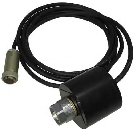
Преобразователь приемный коаксиальный ППК ПрофКиП М3-51 предназначен для преобразования СВЧ мощности в тепловой вид энергии, для измерения образуемой на выходе ППК термоэлектродвижущей силы (термо-ЭДС, которая пропорциональна подведенной к нему мощности СВЧ сигнала) блоком ваттметра измерительным ПрофКиП Я2М-66М (БИ).
