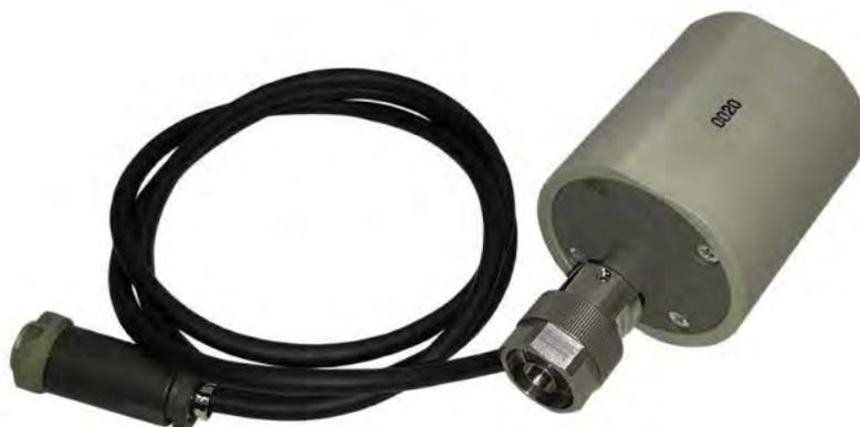
Преобразователь приемный коаксиальный ППК ПрофКиП МЗ-54 предназначен для преобразования СВЧ мощности в тепловой вид энергии, для измерения образуемой на выходе ППК термоэлектродвижущей силы (термо-ЭДС, которая пропорциональна подведенной к нему мощности СВЧ сигнала) блоком ваттметра измерительным ПрофКиП Я2М-66М (БИ).
