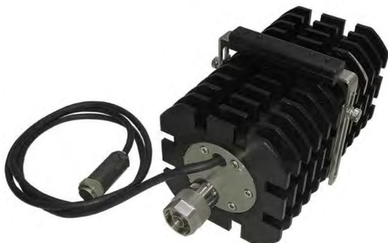
Преобразователь приемный коаксиальный ППК ПрофКиП МЗ-56 предназначен для преобразования СВЧ мощности в тепловой вид энергии, для измерения образуемой на выходе ППК термоэлектродвижущей силы (термо-ЭДС, которая пропорциональна подведенной к нему мощности СВЧ сигнала) блоком ваттметра измерительным ПрофКиП Я2М-66М (БИ).
