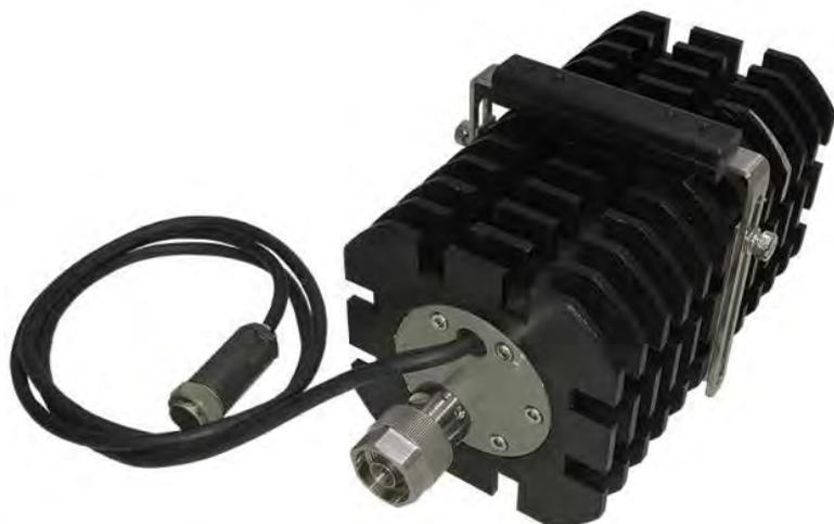
Преобразователь приемный коаксиальный ППК ПрофКип МЗ-56/1 предназначен для преобразования СВЧ мощности в тепловой вид энергии, для измерения образуемой на выходе ППК термоэлектродвижущей силы (термо-ЭДС, которая пропорциональна подведенной к нему мощности СВЧ сигнала) блоком ваттметра измерительным ПрофКип Я2М-66М (БИ).
