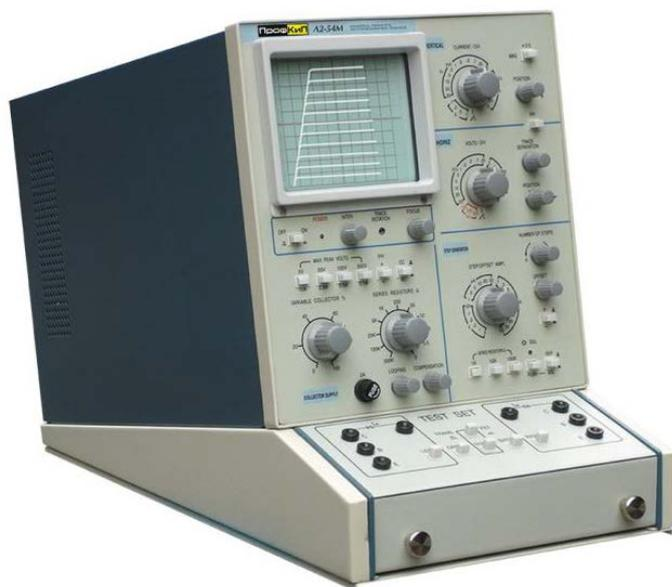
предназначен для определения работоспособности маломощных транзисторов и диодов малой и средней мощности путем измерения их основных параметров.
