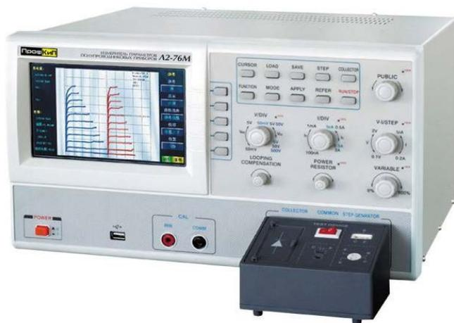
предназначен для оценки годности широкой номенклатуры биполярных транзисторов малой, средней и большой мощности, диодов и стабилитронов путем проверки основных статических параметров.
