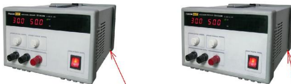
Рисунок 2 – Схема пломбировки от несанкционированного доступа.
