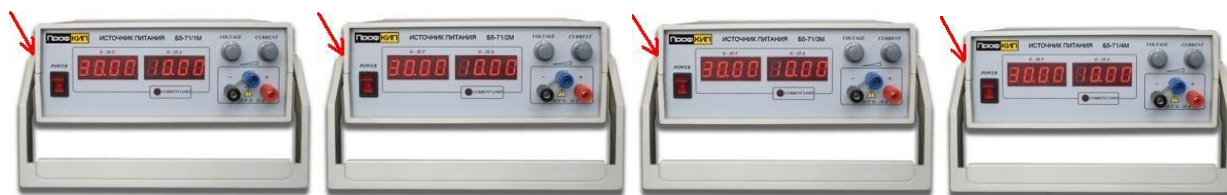
Рисунок 2 – Схема пломбировки от несанкционированного доступа.
