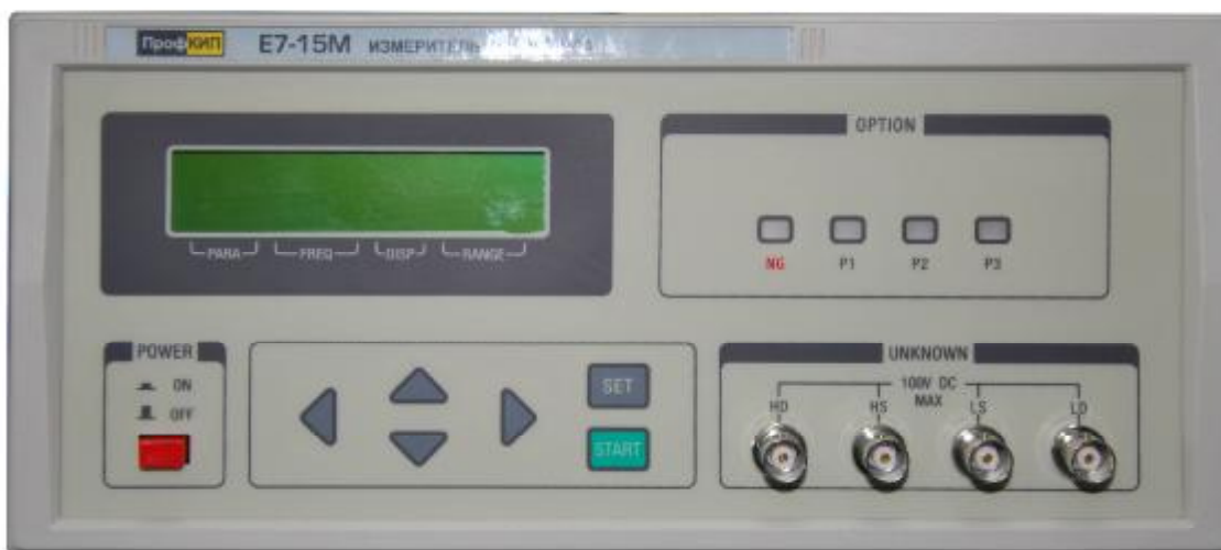
Рисунок 1 – Общий вид передней панели измерителя иммитанса
