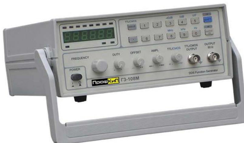
Генератор сигналов низкочастотный ПрофКип ГЗ-108М предназначен для исследования, настройки и испытаний систем и приборов, используемых в радиоэлектронике, связи, автоматике, вычислительной и измерительной технике, приборостроении. Прибор обеспечивает формирование сигналов прямоугольной, треугольной, синусоидальной формы, а также импульсов TTL уровней в диапазоне частот от 0.1 Гц до 3 МГц.
