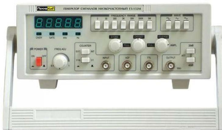
Генератор сигналов низкочастотный ПрофКиП ГЗ-132М предназначен для исследования, настройки и испытаний систем и приборов, используемых в радиоэлектронике, связи, автоматике, вычислительной и измерительной технике, приборостроении. Прибор обеспечивает формирование сигналов прямоугольной, треугольной, синусоидальной формы, а также импульсов TTL уровней в диапазоне частот от 0.03 Гц до 3 МГц.
