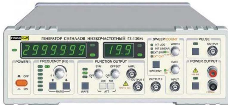
Генератор сигналов низкочастотный ПрофКиП ГЗ-130М позволяет получать стабильные сигналы с малыми искажениями в диапазоне частоты до 3 МГц. Типичные применения включают проверку аппаратуры звукового и ультразвукового диапазона, испытание на вибрацию, проверку сервоприводов и т.д. Генератор сигналов ГЗ-130М выдает многообразные формы сигналов: синусоида, треугольная, прямоугольная, пилообразная, импульс и имеет встроенный частотомер.
