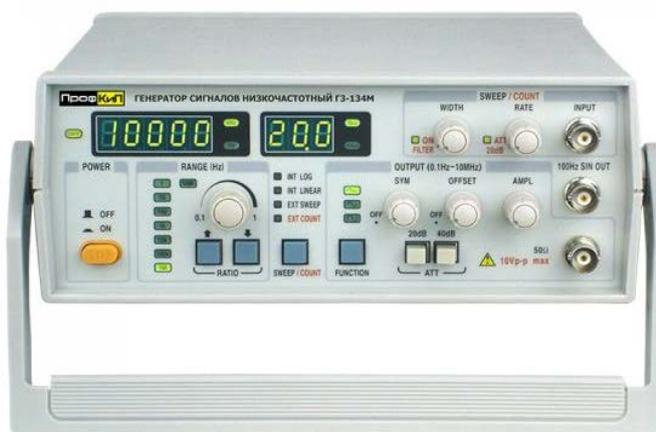
Генератор сигналов низкочастотный ПрофКиП ГЗ-134М предназначен для исследования, настройки и испытаний систем и приборов, используемых в радиоэлектронике, связи, автоматике, вычислительной и измерительной технике, приборостроении. Прибор обеспечивает формирование сигналов прямоугольной, треугольной, синусоидальной и другой формы.
