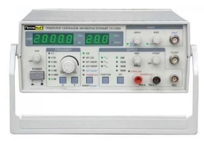
Генератор сигналов низкочастотный ПрофКиП Г3-129М предназначен для исследования, настройки и испытаний систем и приборов, используемых в радиоэлектронике, связи, автоматике, вычислительной и измерительной технике, приборостроении. Генератор сигналов низкочастотный ПрофКиП Г3-129М обеспечивает формирование сигналов прямоугольной, треугольной, синусоидальной и др. формы.
