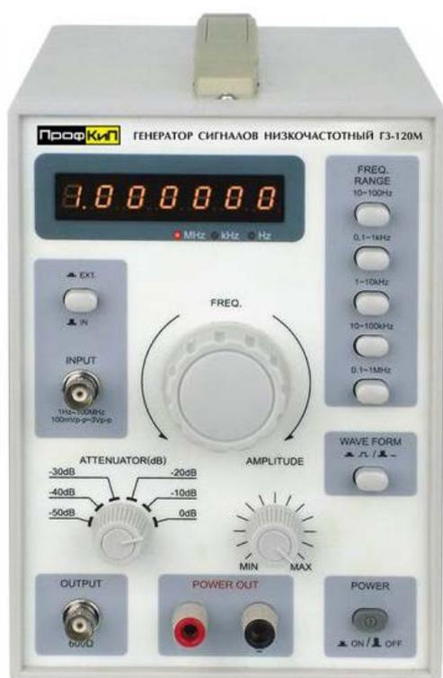
Генератор сигналов низкочастотный ПрофКиП ГЗ-120М является малогабаритным аудио-генератором. Установка частоты осуществляется плавно в пределах одного поддиапазона. Всего в генераторе пять поддиапазонов, предназначенных для эксплуатации в жестких условиях. Синхронизация частоты генератора сигналов низкочастотного ПрофКиП ГЗ-120М может осуществляться внешними сигналами в независимости от их формы.
