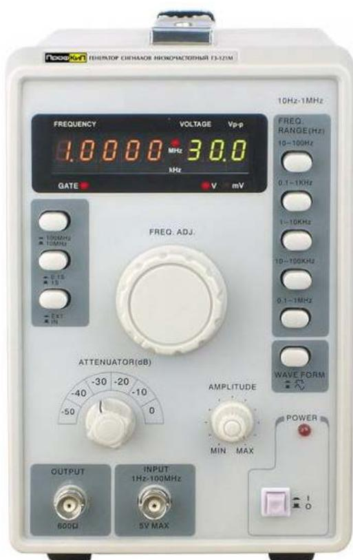
Генератор сигналов низкочастотный ПрофКиП ГЗ-121М является малогабаритным аудио-генератором. Установка частоты осуществляется плавно в пределах одного поддиапазона. Всего в генераторе пять поддиапазонов, предназначенных для эксплуатации в жестких условиях. Синхронизация частоты генератора сигналов низкочастотного ПрофКиП ГЗ-121М может осуществляться внешними сигналами в независимости от их формы.
