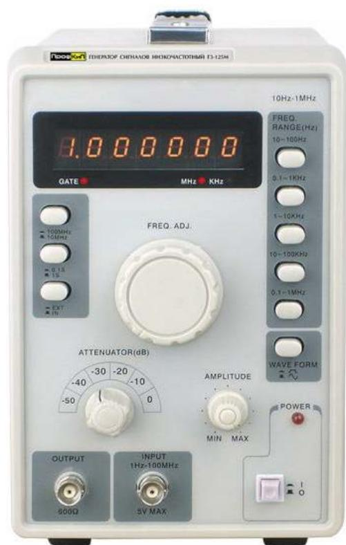
Генератор сигналов низкочастотный ПрофКип ГЗ-125М является малогабаритным аудио-генератором. Установка частоты осуществляется плавно в пределах одного поддиапазона. Всего в генераторе пять поддиапазонов, предназначенных для эксплуатации в жестких условиях. Синхронизация частоты генератора сигналов низкочастотного ПрофКип ГЗ-125М может осуществляться внешними сигналами в независимости от их формы.
