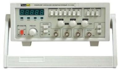
Генератор сигналов низкочастотный ПрофКиП Г3-133М предназначен для исследования, настройки и испытаний систем и приборов, используемых в радиоэлектронике, связи, автоматике, вычислительной и измерительной технике, приборостроении. Прибор обеспечивает формирование сигналов прямоугольной, треугольной, синусоидальной формы, а также импульсов ТТL уровней в диапазоне частот от 0.06 Гц до 6 МГц.
