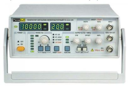
Генератор сигналов низкочастотный ПрофКиП Г3-112/1М предназначен для исследования, настройки и испытаний систем и приборов, используемых в радиоэлектронике, связи, автоматике, вычислительной и измерительной технике, приборостроении. Прибор обеспечивает формирование сигналов прямоугольной, треугольной, синусоидальной и другой формы.
