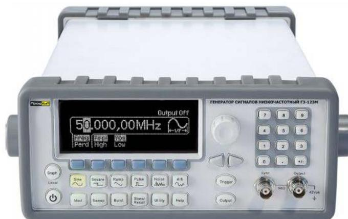
Генератор сигналов ПрофКип ГЗ-123М представляет собой источник синусоидального сигнала с повышенной выходной мощностью. Предназначен для исследования, настройки и испытаний систем, и приборов, используемых в радиоэлектронике, связи, автоматике, вычислительной и измерительной технике, приборостроении.
