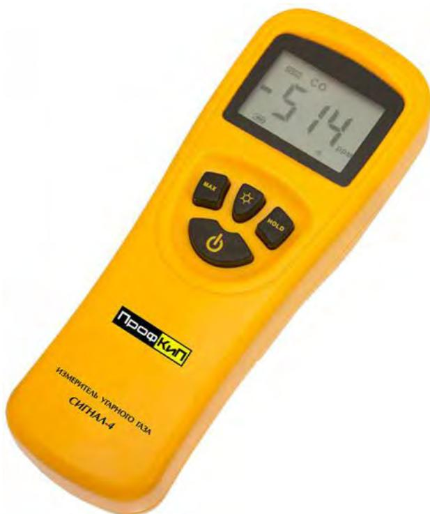
Измеритель угарного газа ПрофКип Сигнал-4 позволяет не только проанализировать наличие угарного газа в окружающем воздухе, но и измерить количественный состав газа. Детектор угарного газа измеряет количество угарного газа в количестве взвешенных частиц на единицу объема воздуха. В газоанализаторе данной модели в качестве газового датчика применен сложный электрохимический преобразователь. Срок службы электрохимического датчика газа в измерителе угарного газа ПрофКип Сигнал-4 составляет три года.
