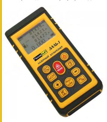
Лазерный дальномер ПрофКиП Даль-1 является профессиональным инструментом для точного измерения расстояния до целевого объекта. Дальномер использует в своей работе лазерную технологию. Цифровой лазерный дальномер умеет не только измерять расстояние, он позволяет вычислять площади помещений, а также объемы. Функционал устройства позволяет суммировать показания.
