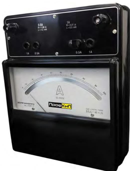
Амперметр лабораторный ПрофКиП Э538М – электромагнитный измерительный прибор, предназначенный для измерения силы переменного и постоянного электрического тока.
