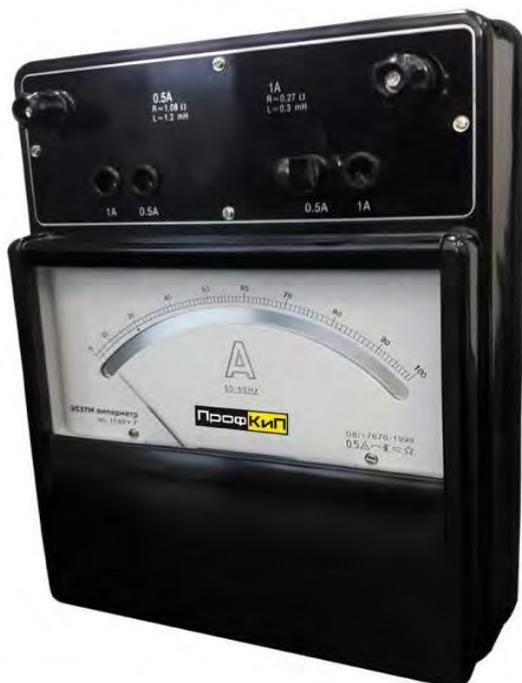
Амперметр лабораторный ПрофКип Э537М – электромагнитный измерительный прибор, предназначенный для измерения силы переменного и постоянного электрического тока.
