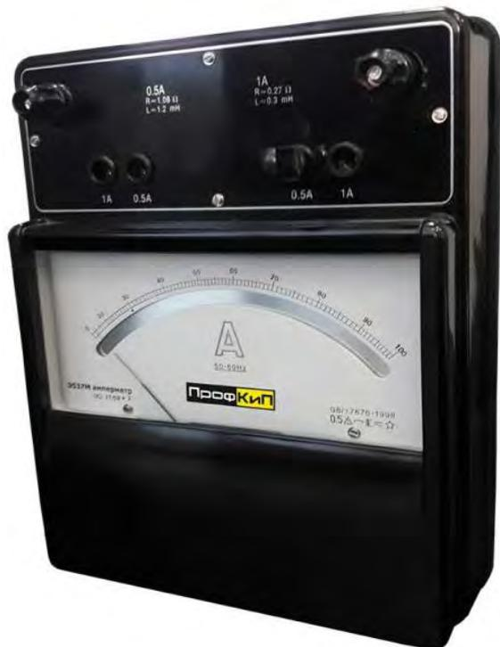
Миллиамперметр лабораторный ПрофКип Э535М – электромагнитный измерительный прибор, предназначенный для измерения силы переменного и постоянного электрического тока.
