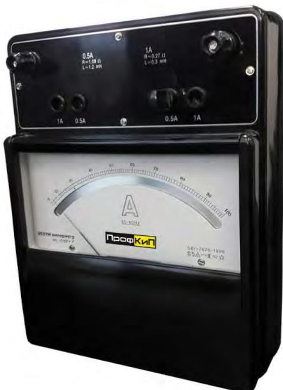
Амперметр лабораторный ПрофКип Э539М – электромагнитный измерительный прибор, предназначенный для измерения силы переменного и постоянного электрического тока.
