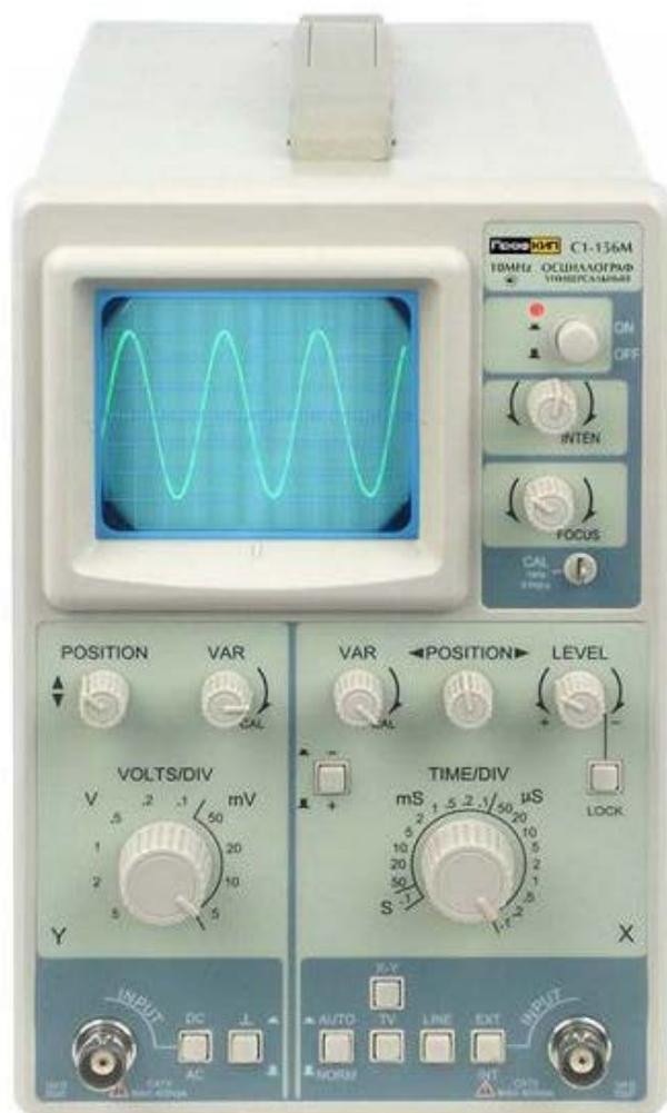
Осциллограф универсальный ПрофКиП С1-156М предназначен для исследования формы периодических электрических сигналов путем визуального наблюдения и измерения амплитуд в диапазоне от 0 МГц до 10 МГц. Рекомендован для использования в образовательных учреждениях.
