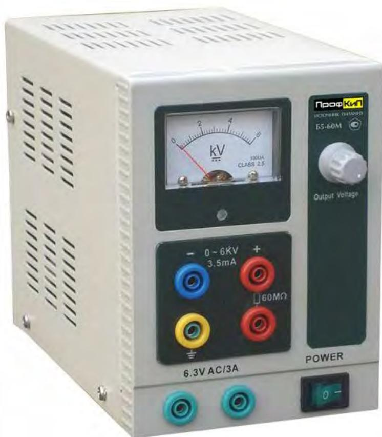
Аналоговый источник питания ПрофКип Б5-60М предназначен для проведения работ в процессах наладки, ремонта и лабораторных исследований. Приборы выдают плавно регулируемое постоянное стабилизированное напряжение и стабилизированный ток.
